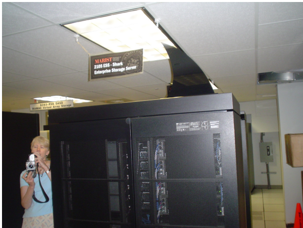
Figure: Příklad DASD: Shark s 200 x 60 GB disků
